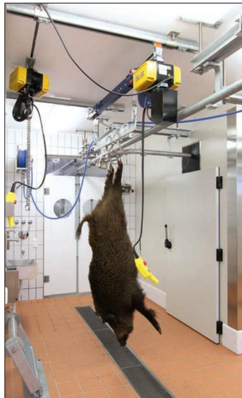
▲ Festeinbau mit Rohrbahnsystem, Waage, Kühlkammer
